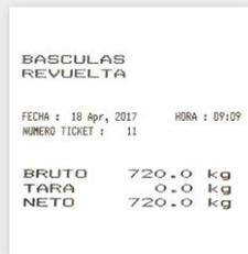
**Nota:** El formato de impresión depende del Indicador Digital de Peso o fuente de datos con que esté conectado el Impresor. La operación del impresor es cautiva o en forma de esclavo.
