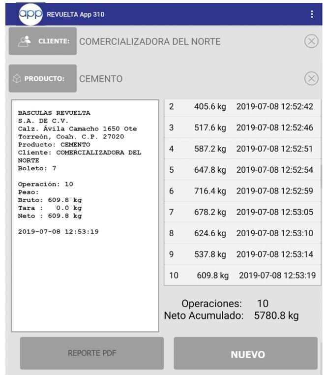
**2.5 CAPTURA DE PESO.** Para realizar una captura de peso coloque el producto en la plataforma y presione **[CAPTURAR]**. Si la operación de pesaje fue válida\* esta se acumulará en el boleto actual incluyendo los datos de fecha y hora de la operación.
