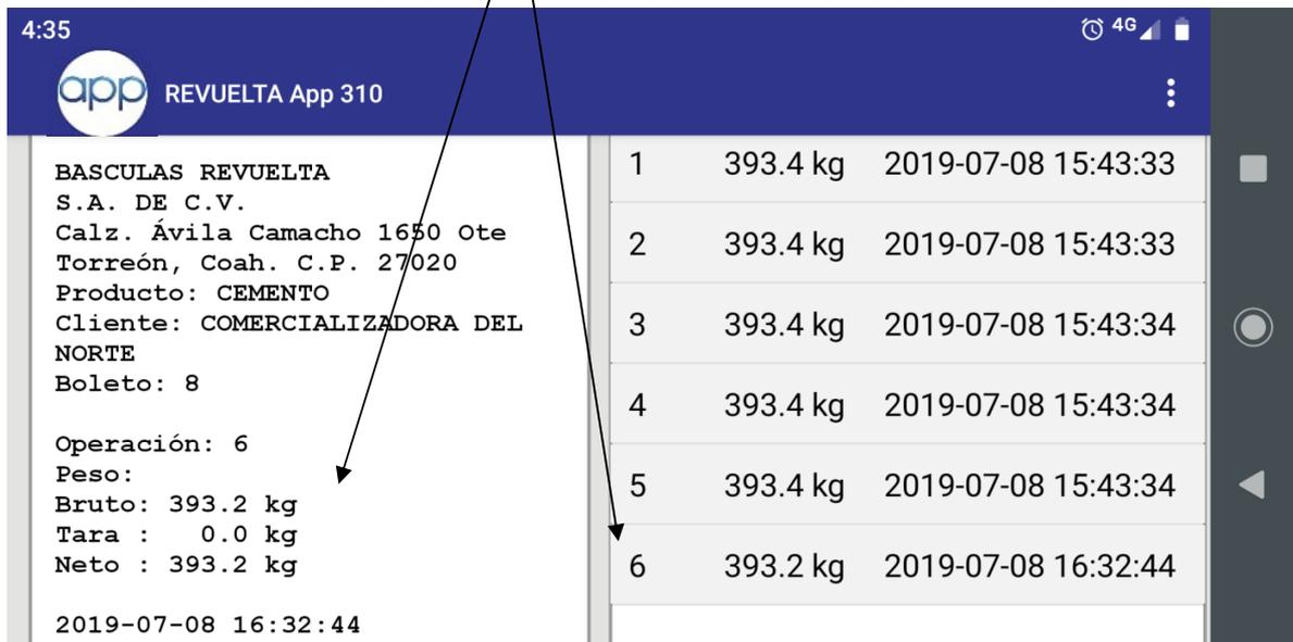
\* Una operación de captura será válida dependiendo de la configuración en el apartado 8 "Opciones" ya que puede estar sujeta a validación de "retorno a cero" (RET A CERO / para evitar el duplicado de capturas) ó al "factor de estabilidad" para asegurar una operación de pesaje correcta.
